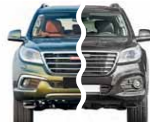
Машина после рестайлинга 2017 года проще опознать по измененным переднему бамперу с иным обрамлением противотуманных фар и решетке радиатора с пятью хромированными ребрами вместо трех
